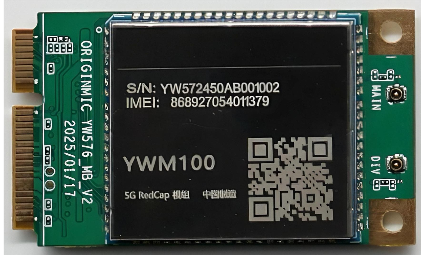
YWM100系列5G RedCap模组基于3GPP Release17技术，支持5G SA组网，向下兼容LTE和WCDMA，频段符合中国四大运营商要求。上下行理论峰值速率分别可达226Mbps (DL) 和 120Mbps (UL)，满足中高速通信的行业应用要求。
